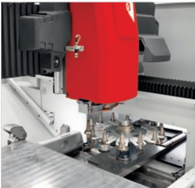
Magasin d'outils rotatif sur lequel il est possible de charger les outils en toute sécurité tandis que la machine usine.
